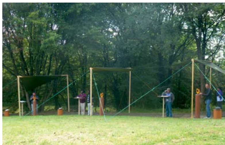
Illustration de la campagne d'inter-comparaison de mesures absolues : trois équipes mesurent l'inclinaison et la déclinaison du champ magnétique terrestre.
