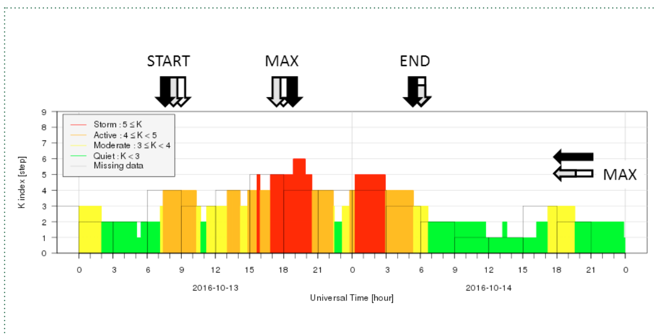
Fig. 1 : La prévision à très court terme de l'indice K^* avec une résolution d'1 minute, basée sur des mesures de magnétogrammes digitaux à Doubes, durant la tempête magnétique des 13 et 14 octobre 2016. Les blocs aux contours noirs indiquent les valeurs tri-horaires standard de l'indice et les blocs de couleurs représentent les valeurs par minute. L'amélioration d'une prévision à une résolution de 3 heures (flèches blanches) vers 1 minute (flèches noires), est de 95 minutes à partir du début de l'heure de début de la tempête, 53 minutes pour son maximum et 40 minutes pour sa fin. La puissance de la tempête est corrigée avec 1 unité de K .
