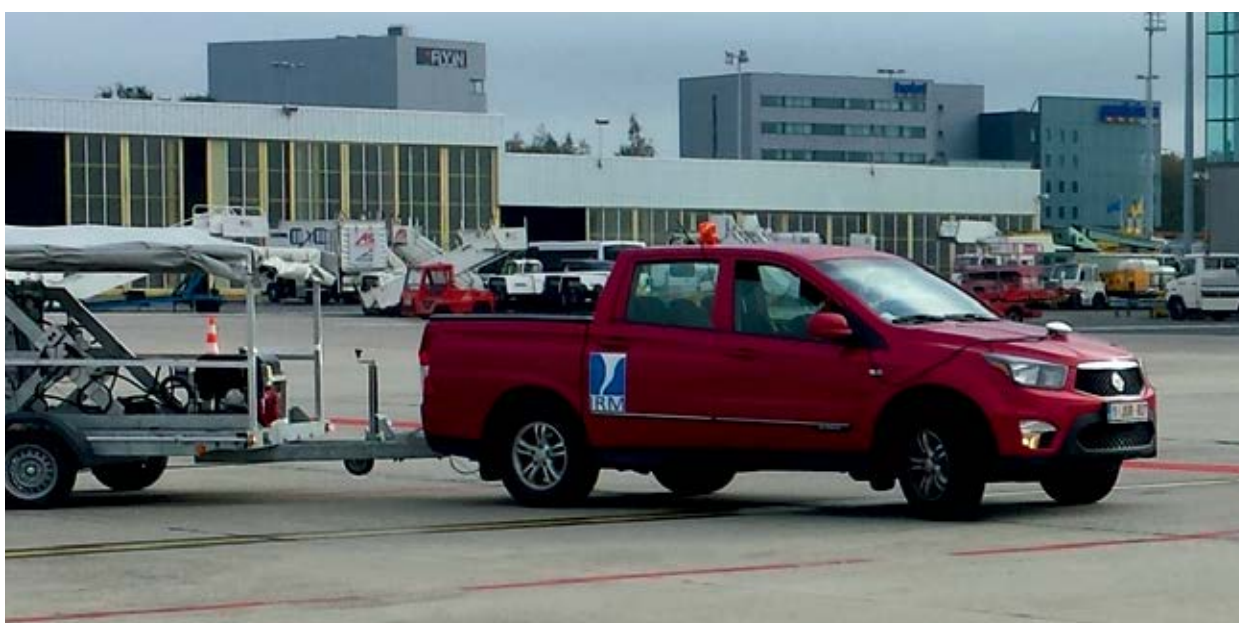
Dispositif pour démagnétiser la Dalle Sud de Liège Airport.
