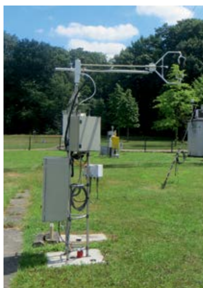
Fig.: Système de mesure des flux turbulents en phase de test à Uccle en 2016 (vue d'ensemble en bas et détail de l'anémomètre sonore au-dessus).
